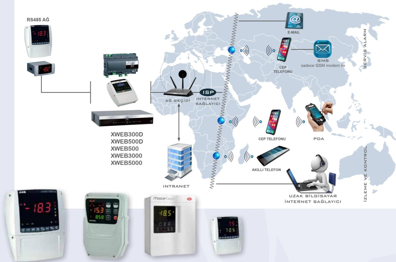
Kühlraumregelungselemente sind eine Art von Regelungsinstrumenten, die die Raumtemperatur und die Luftfeuchtigkeit konstant auf dem gewünschten Niveau halten können. Steuergeräte werden dort eingesetzt, wo Temperatur und Feuchtigkeit einstellbar sein sollen, wie Kühlräume und Kühlhäuser.
