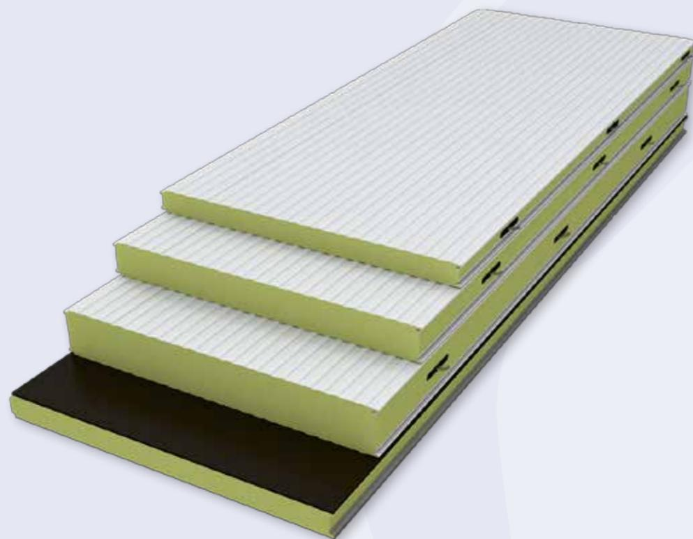
Mit Polyurethan gefüllte Sandwichpaneel werden in der industriellen Kühllagerung eingesetzt. Polyurethan, das als Kernmaterial verwendet wird, enthält aufgrund seiner chemischen Struktur keine gesundheitsschädlichen Organismen. Aufgrund seines niedrigen Wärmeleitfähigkeitskoeffizienten bietet es eine hervorragende Wärmedämmung.
