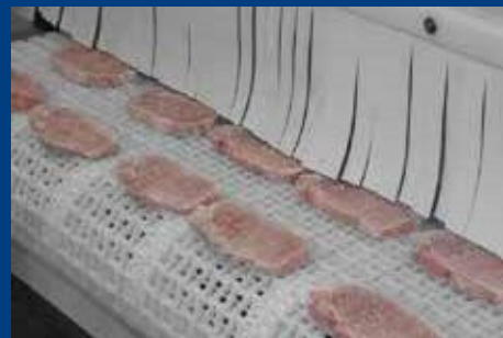
Tunnel de Congélation
